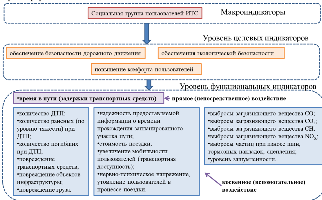
Рисунок 4 - Схема архитектуры индикаторов эффективности ЛП ИТС по автоматизированному управлению дорожным движением
